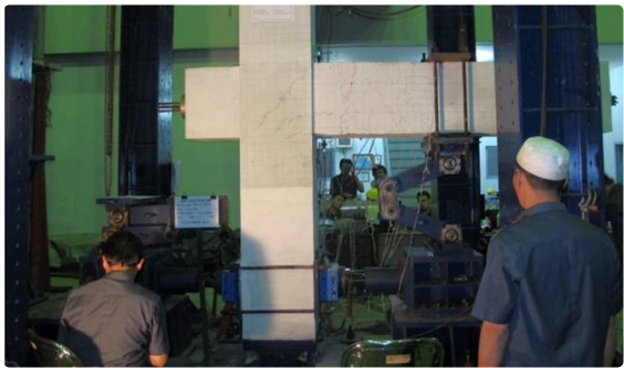
PRESSS Column-Joint Certification at Laboratorium Pengujian Pusat Penelitian dan Pengembangan Perumahan dan Pemukiman - Bandung, West Java
